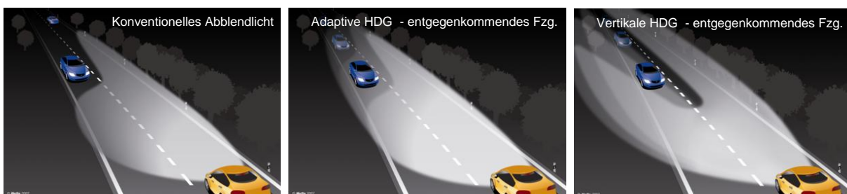
Abbildung 4: Prinzipdarstellung der adaptiven- und vertikalen HDG im Vergleich zu konventionellem Abblendlicht.
