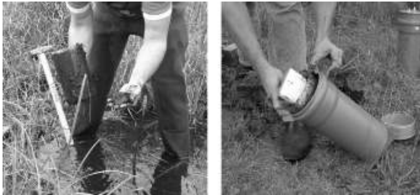
Abb. 7.7.2 Entnahme von intakten Torfkernen (links) und Inkubationsgefäß mit Kern und integriertem Dialysesammler für die Bestimmung von Stofffreisetzungsraten (rechts).
