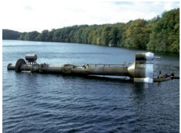
*Für künstliche Calcitfällungen modifiziertes Tiefenwasserbelüftungsaggregat (TIBEAN) während der Umsetzung im Schmalen Luzin*
