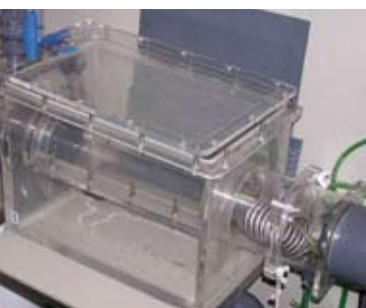
Abb. 2 Schwimmstunnel-Respirometer, in dem der Sauerstoffverbrauch der Fische gemessen wurde (Foto: J. Ohlberger)
