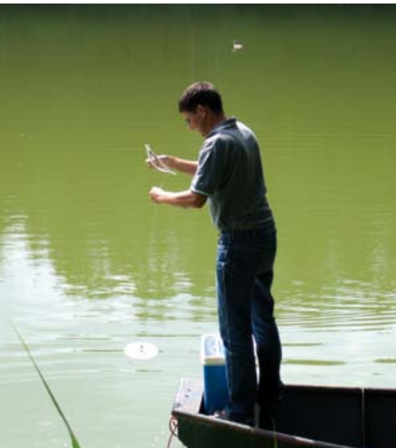
Messung der Sichttiefe mit der Secchi-Scheibe: je intensiver die Phytoplanktonentwicklung, desto geringer ist die Sichttiefe.
