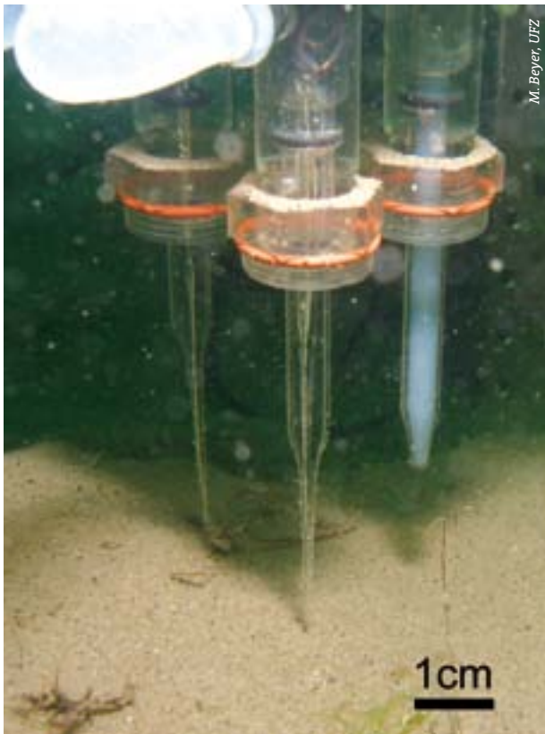
Zeitlich und vertikal hochauflösende Messungen der Sauerstoff- und pH-Gradienten zwischen Sediment und Wasser im Stechlinsee mittels Mikrosensoren (Durchmesser 50 µm), die an einem Lander befestigt sind.
