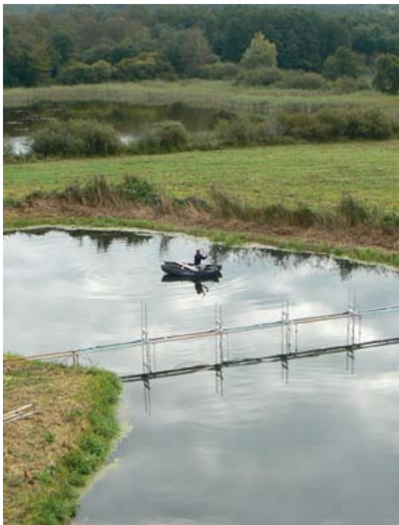
Felduntersuchung turbulenter Strömung in einer Mäanderschlinge der Tollense.
