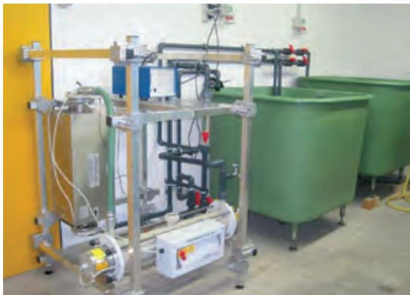
*Kombinierter Ultraschall/UV-Licht Reaktor als Prototyp am IGB*
