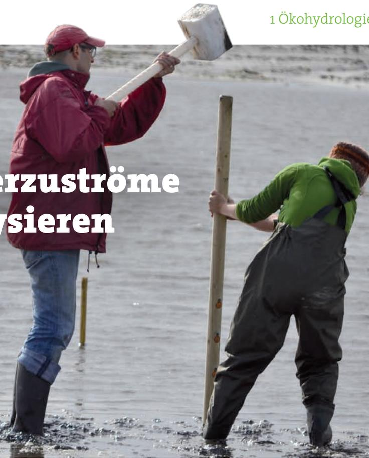
*Die Wissenschaftler installieren eine Temperaturlanze zur Erfassung des Grundwasserzustroms.*
