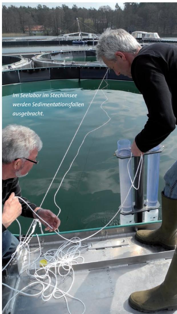
Im Seelabor im Stechlinsee werden Sedimentationsfallen ausgebracht.
