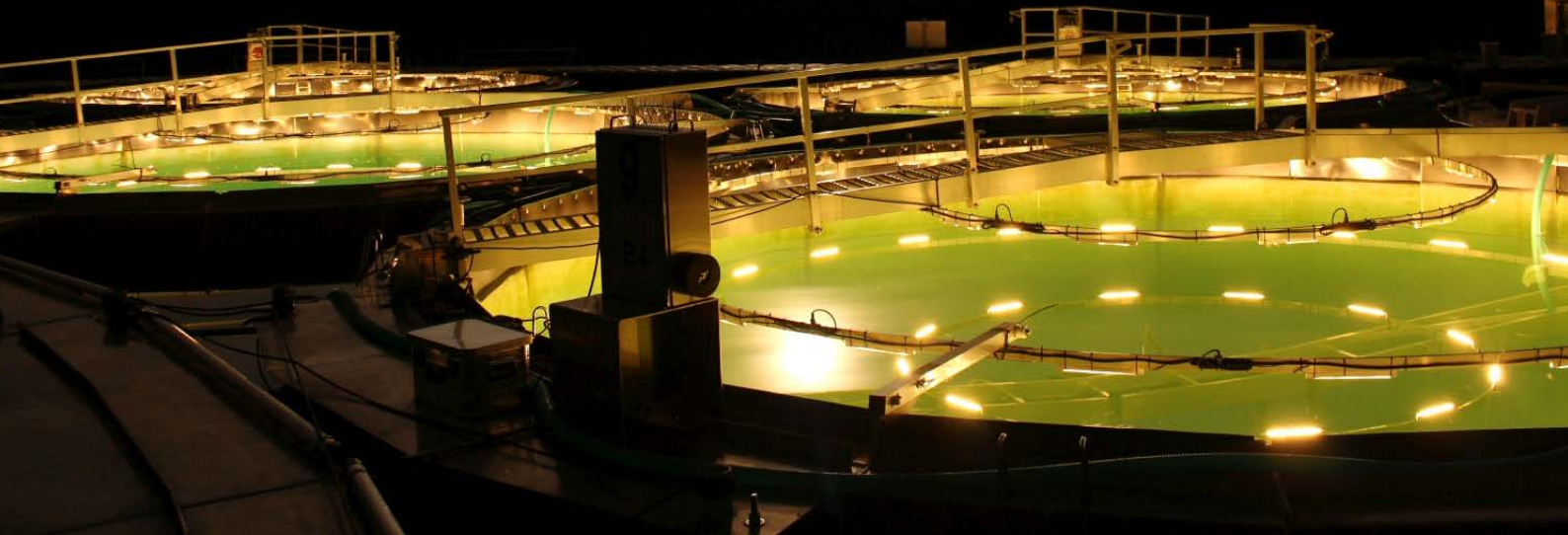
Aufbau des Beleuchtungssystems zur Simulation von Himmelsleuchten am Seelabor.
