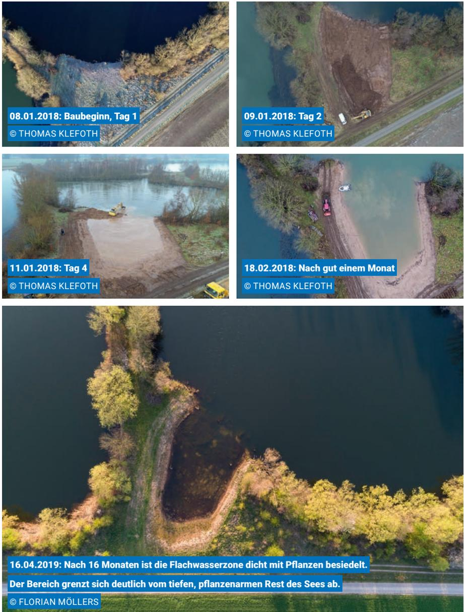
Abbildung 131: Entwicklung einer Flachwasserzone.
