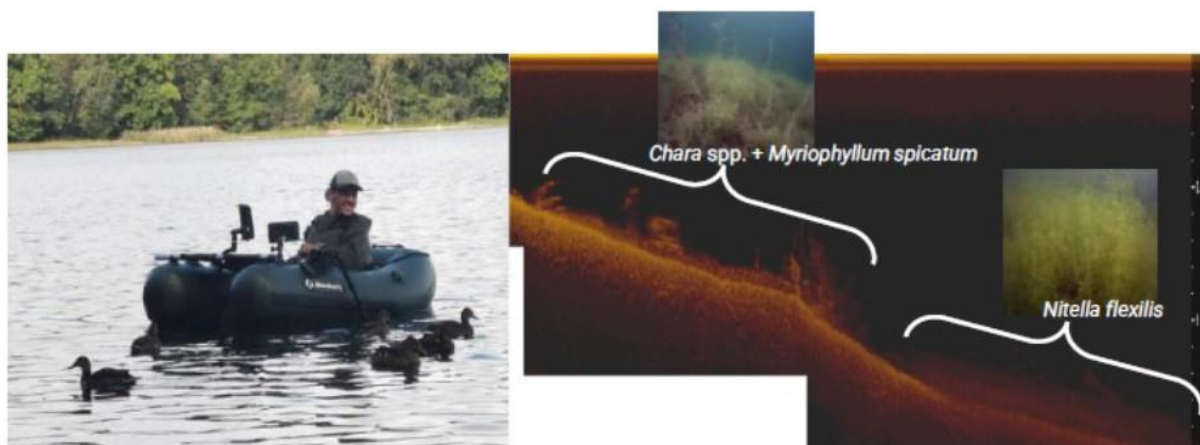
Abb. 6: Ermittlung der Unterwasservegetation mithilfe einer Unterwasserkamera und Echolot (Foto: C. Levertz)
