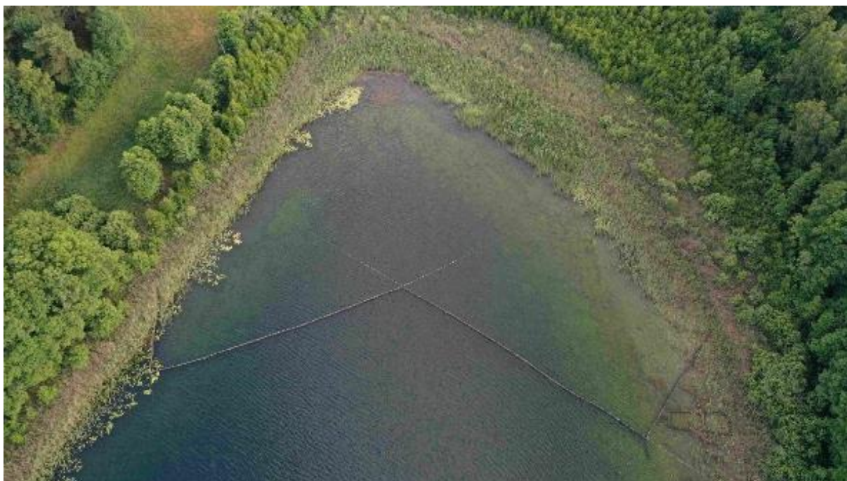
Abb. 41: Leiteinrichtung in der Südspitze des Gollinsees. Außer dem in W-Form gebauten Netz sind Spannseile zu erkennen. In den Spitzen im Bildvordergrund befinden sich wie Reusenkehlen geformte Ausschwimmöffnungen (Foto: A. Bormeister, 2023)
